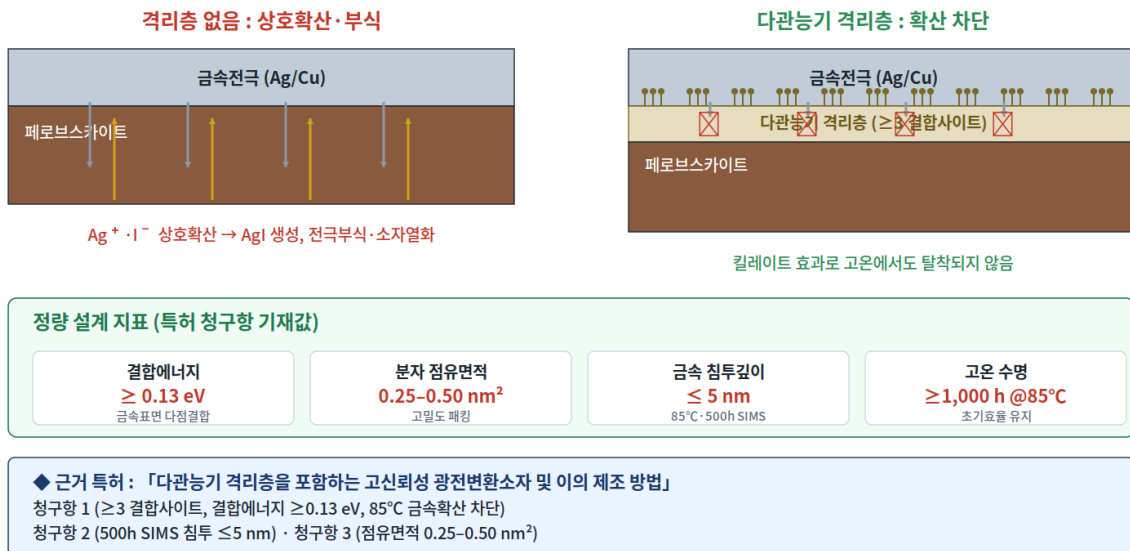
[그림 7] 격리층이 없을 때의 상호확산(왼쪽)과 다관능기 격리층에 의한 확산 차단(오른쪽)
