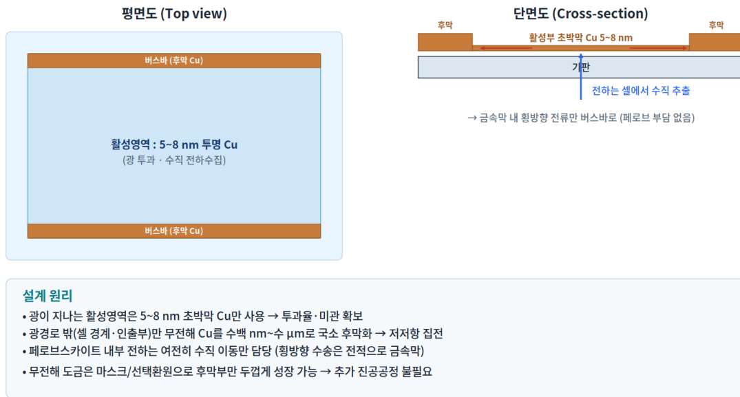
[그림 12] 활성영역 초박막 Cu와 인출부 후막 Cu를 나눈 대면적 집전 구조
