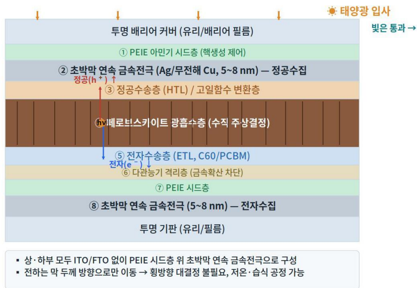
[그림 1] 광 입사측부터 기판까지의 소자 단면. 상·하부 전극 모두 PEIE 시드층 위 초박막 연속 금속막이다
