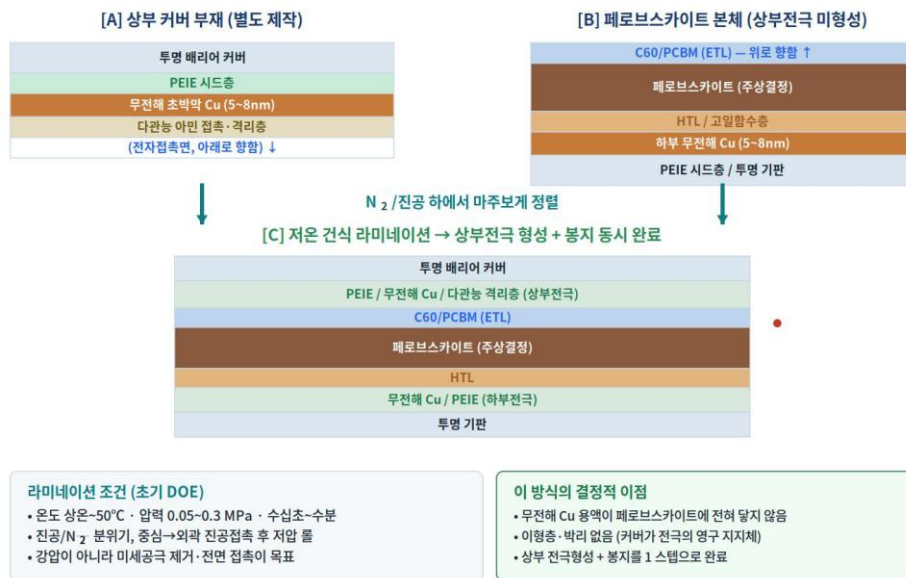
[그림 10] 상부 커버 부재[A], 페로브스카이트 본체[B], 저온 건식 라미네이션 결과[C]. 상부 전극 형성과 봉지가 동시에 끝난다
