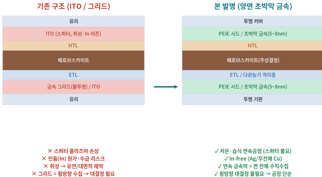
[그림 2] 기존 ITO·그리드 구조(왼쪽)와 양면 초박막 금속 구조(오른쪽)의 비교
