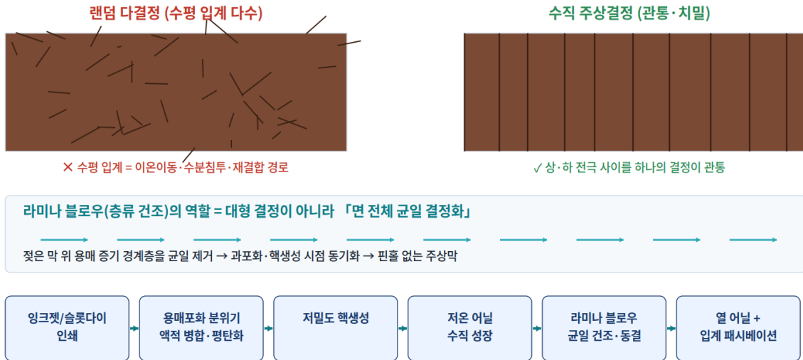
[그림 4] 랜덤 다결정(왼쪽 위)과 수직 주상결정(오른쪽 위), 라미나 블로우 균일 건조를 포함한 공정 순서(아래)
