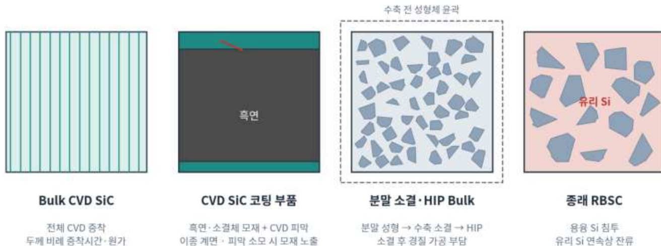
기존 SiC 부품 제조 경로의 단면 구조
